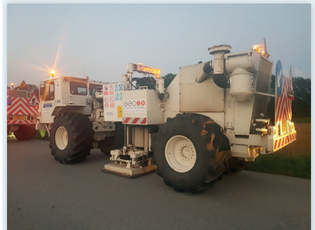
Zwischen den Rädern des Vibrofahrzeuges ist die Platte zu sehen. An den Messpunkten wird diese abgesenkt und der Boden während maximal 30 Sekunden vibriert.
