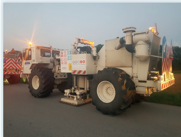
La dalle peut être vue entre les roues sous le véhicule vibreur. Aux points de mesure, celle-ci est abaissée et le sol vibre pendant un maximum de 30 secondes.
